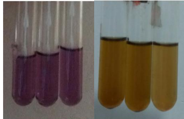
Figure 2 : Solution du DPPH° (à gauche) et mélange de la solution du DPPH° avec l'extrait après 30min à différent concentration (à droite)
